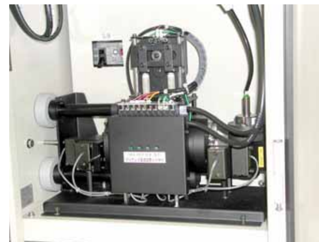
長光路 (100mm) センサー装着状況
